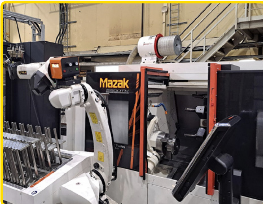
Mazak sorvin päällä Tekupitin toimittama Microil-öljysumuri HEPA suodattimella
