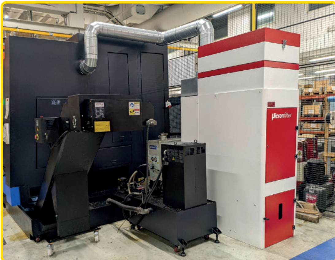
Suuri työstökone vaatii tehokkaan suodatuksen; kuvassa ECOTECH 4000 öljysumuimuri ja Tekupitin samaan koneeseen toimittama lastunkuljetin.
